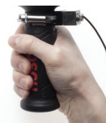
SV 150 Trójosiowy przetwornik do pomiaru drgań na narzędziu
