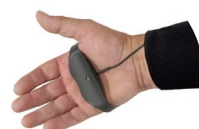
SV 105F Trójosiowy czujnik do pomiaru drgań miejscowych wraz z pomiarem siły uchwytu
