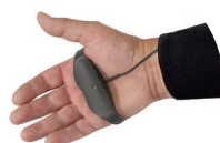
SV 105 Trójosiowy czujnik do pomiaru drgań miejscowych
