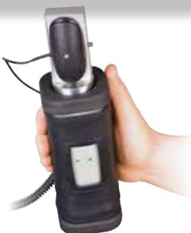
Mit dem optional erhältlichen Kalibrator SV 110 kann vor Ort sehr einfach eine Kalibrierung des SV 103 durchgeführt werden. Der Sensor des SV 103 kann direkt auf den Kalibrator montiert werden. Der Kalibrator liefert die von der Norm geforderten 80 Hz bei einem Vibrationspegel von  $10 \text{ m/s}^2$ .
