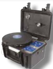
Mit dem optional erhältlichen Kalibrator SV 111 kann vor Ort sehr einfach eine normgerechte Kalibrierung des SV 100A und SV 103 durchgeführt werden. Der SV 100A kann sogar direkt auf den Kalibrator montiert werden. Der eigentliche Sensor muss nicht ausgebaut werden. Der Kalibrator liefert die von der Norm geforderten 16 Hz bei einem Vibrationspegel von  $1 \text{ m/s}^2$ .
