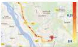
Der SV 100A ermöglicht die Korrelation von GPS-Daten mit den Vibrationsdaten und trägt den Fahrweg auf einer Karte ein, wobei die Farbe die Vibrationsstärken angibt. Diese einfache Lösung bietet ein mächtiges Werkzeug zur Projektion der Vibrationsbelastung A (8) in Bezug auf die Fahrzeuggeschwindigkeit und die Straßenverhältnisse.
