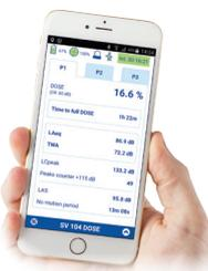
A interface Bluetooth do SV104A permite que os resultados atuais sejam visualizados em um smartphone ou tablet usando nosso **aplicativo Assistente**. O aplicativo de smartphones também sinaliza um alarme quando os limites de ruído são ultrapassados.
